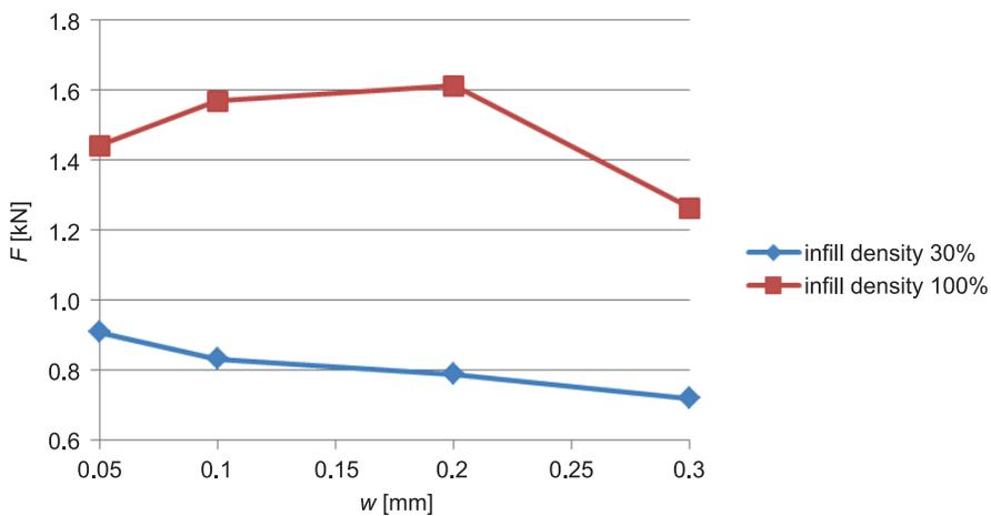
Fig. 3. Mean breaking force values vs. layer height
